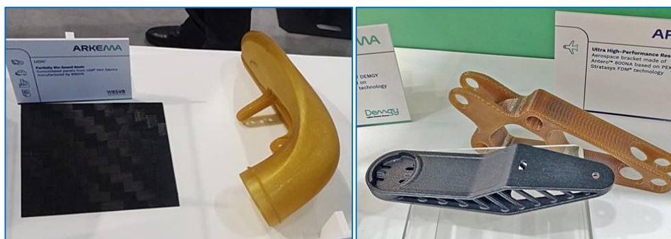
図 24 フィラメント式 3D プリンティングによる航空機の換気ダクト(左)とブラケット(右)
