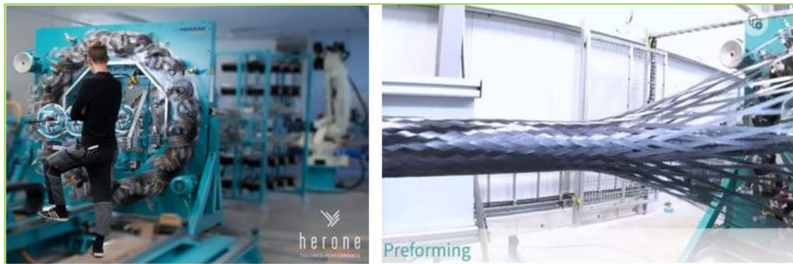
図 15 編組装置と UD テープの編組工程の様子 (Herone)
