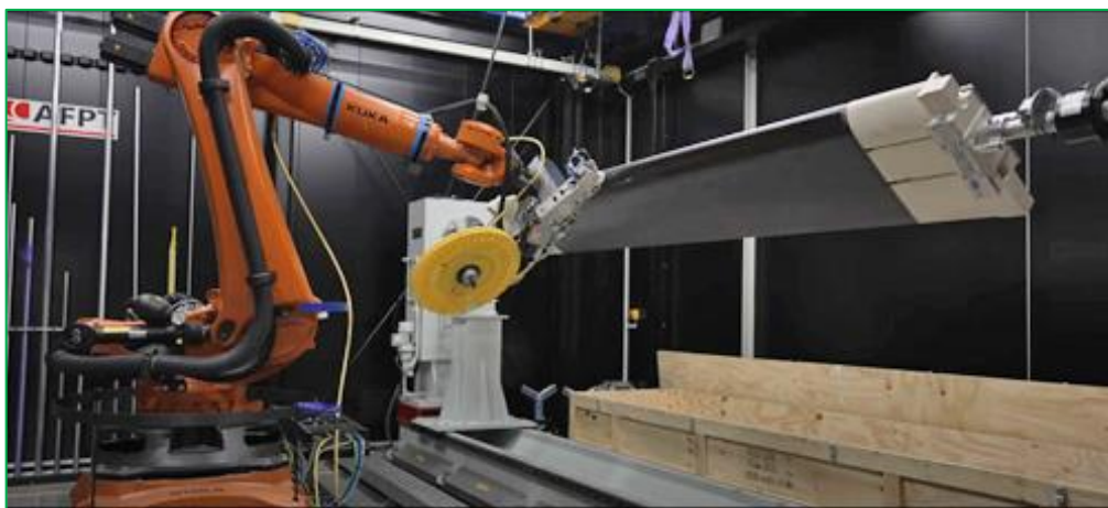
図 6 SPIDE TP によるクルーガーフラップの製造風景 (Cetim)
