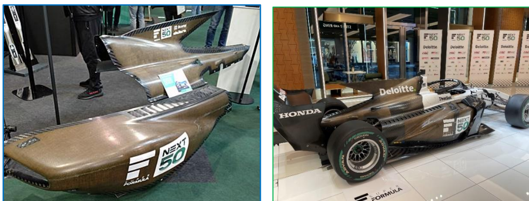
図 20 麻繊維/エポキシ製のボデーパネルとそれを搭載したレースカーSF23 (写真 Bcomp)
