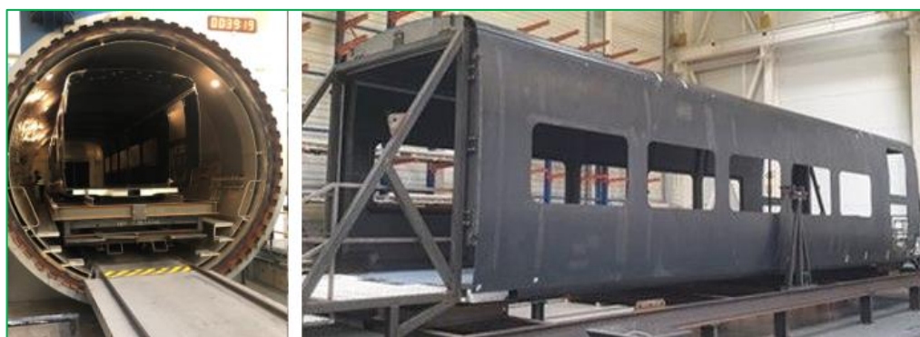
図 14 オートクレーブで成型された CFRP 製ボデー (Talgo)
