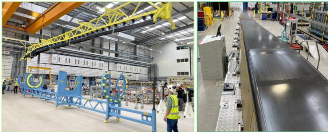
図3 クレーンで吊り下げられた主翼桁と、その表面(写真 GKN Aerospace)
