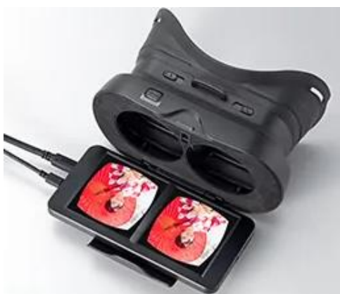
図 4-1 小型の LCD パネルを搭載した VR ゴーグル
