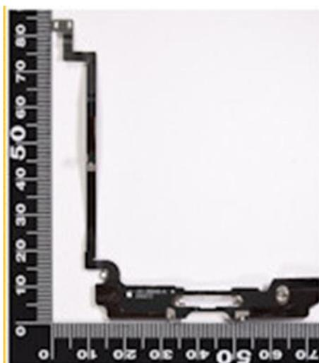
図 3-2-23 LCP 製 FPC 基板のアンテナパーツ
