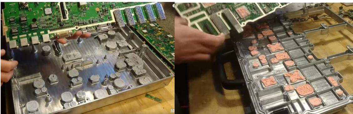
図 5-2-1 RRH、BBU(Nokia Siemens Flexi WCDMA 2100MHz base station)の内部構造
